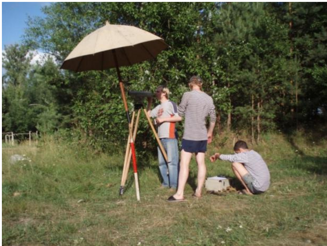
Рисунок 5.13 - Топографический зонт для защиты нивелира от солнечной радиации и одностороннего нагрева, а так же от атмосферных осадков
