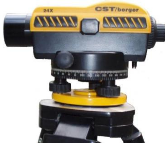
Рисунок 5.14 - Нивелир с компенсатором (с самоустанавливающейся линией визирования) и горизонтальным кругом CST/berger (увеличение 24X)
