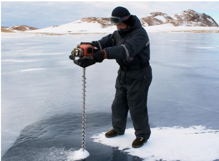
Рисунок 9. 1 - Бурение припайного льда с помощью бура Solo (Фото А.В.Семенова)
