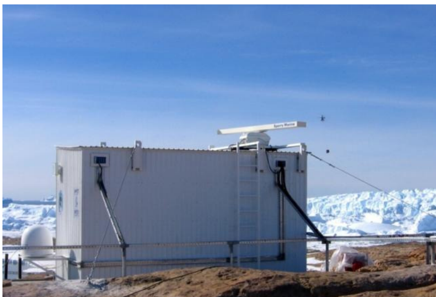
Рисунок 9.14 – Антарктическая станции Прогресс. Панорамная РЛС BRIDGE MASTER E, установленная на холме высотой 61 м для наблюдений за морским льдом и айсбергами в радиусе 30 км, а также динамикой фронта близлежащего выводного ледника Долк (Фото В.Е.Кораблева)
