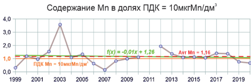
Рис. 4.8. Изменение среднего содержания Mn (в ПДК) в водах Морского торгового порта в 1999-2020 гг.
