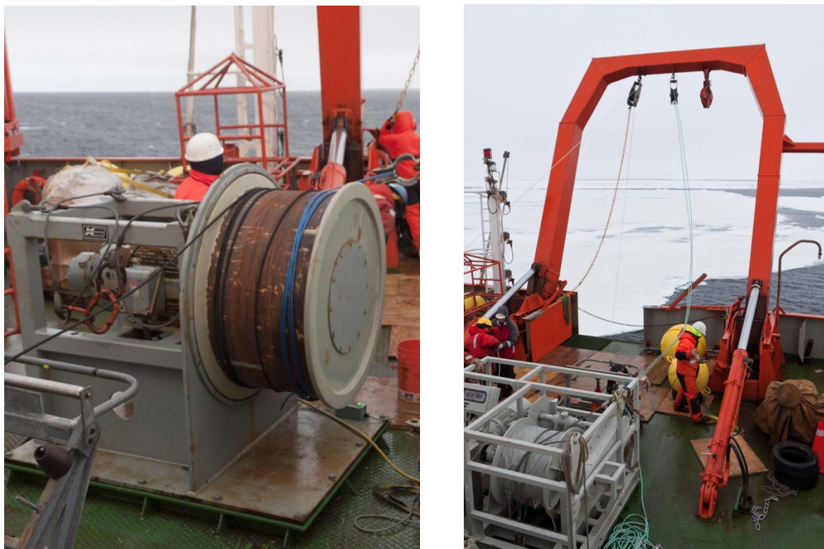
Рис. 17.16 Внешний вид шпиля, лебедки и П-образной рамы с закрепленными блок-шкивами, используемых для постановки притопленных буйковых станций
