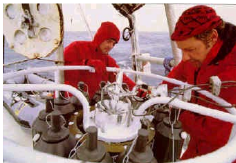
Рис. 7.2 Развертывание батометрической секции SBE 32.
