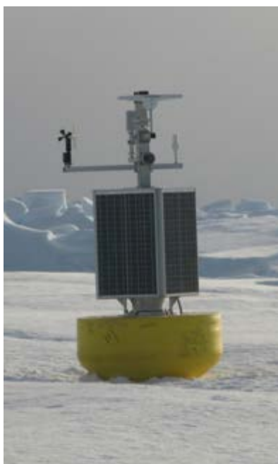
Рис.17.20 О-буй в собранном виде, установленный на лед в рамках выполнения программы экспедиции NABOS-2013
