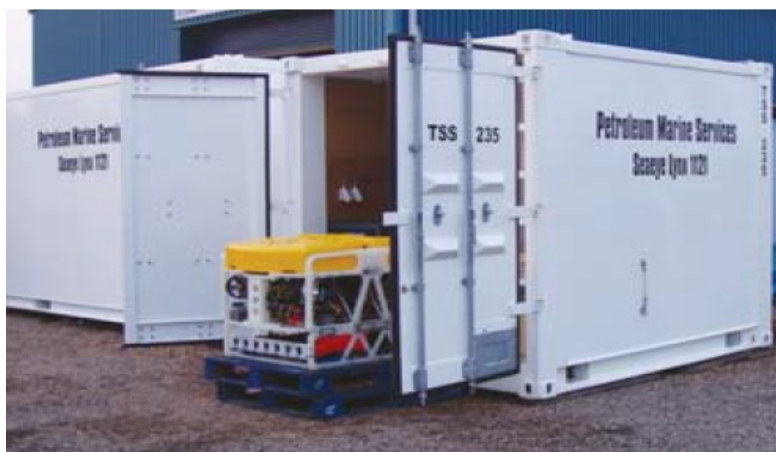
Рис. 6.11 Морские 20-футовые контейнеры, в которых размещается необходимая измерительная техника или спускоподъемные устройства
