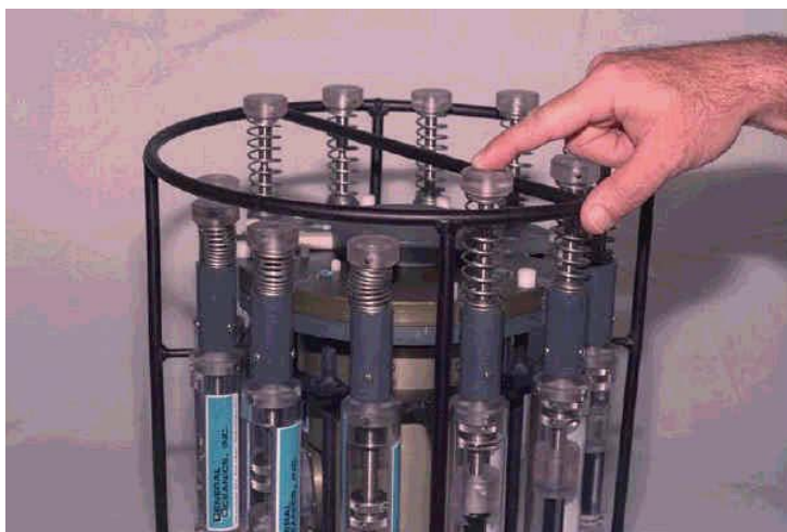
Рис. 7.12 Модель 1014 Syringe Sampler System , клапаны доступа воды в батометры.
