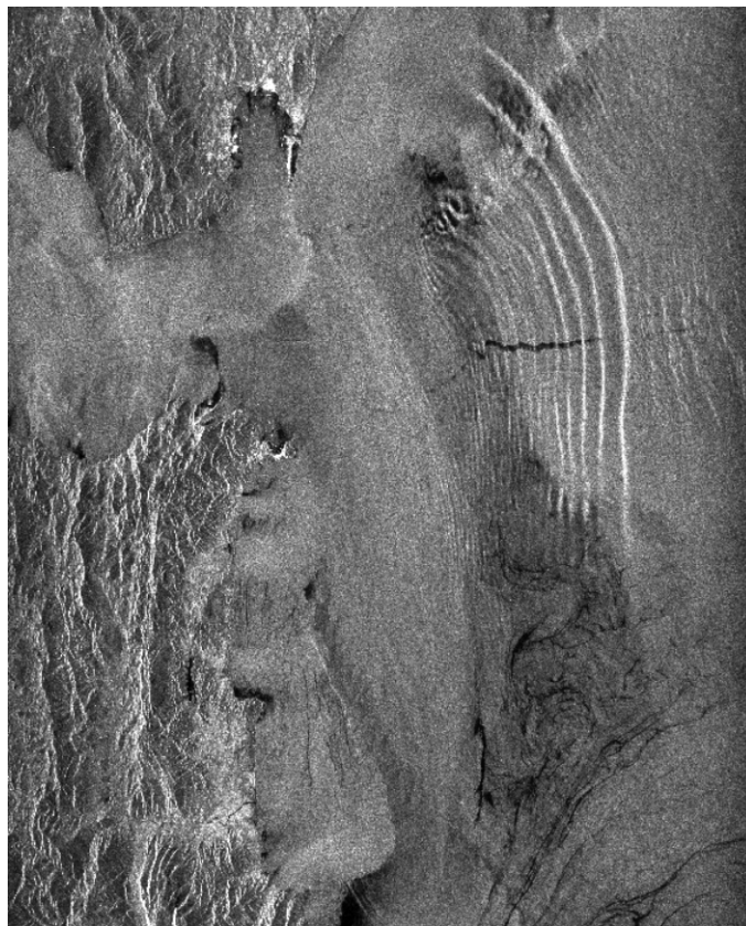
Рис.18.10 Радиолокационное изображение района Гибралтарского пролива, полученное радиолокатором с синтезированной апертурой на европейском спутнике ERS-1.
