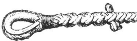
Рис. 6.78 Заделка конца синтетического троса с коушем
