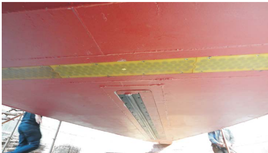
Рис.6.18 Пример врезки МЛЭ ATLAS в днище судна
