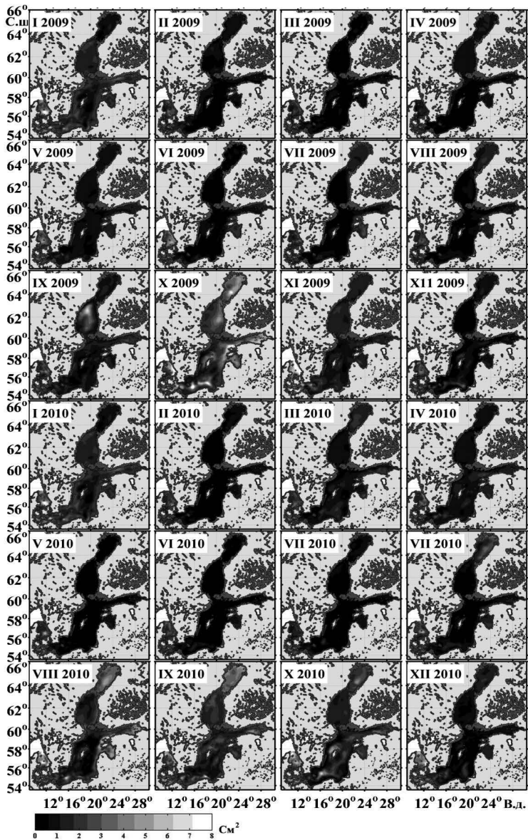
Рис. 8. Дисперсия значений разности между колебаниями уровня, рассчитанными по трёхмерной бароклинической модели и трёхмерной баротропной модели.
