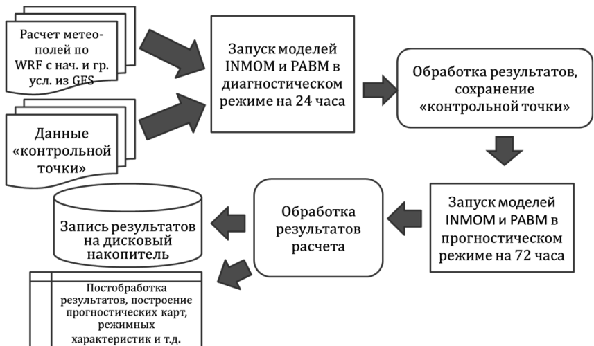
Рис. 1. Блок-схема вычислительной системы MARC, реализованная для комплексного моделирования морской и атмосферной циркуляции, включая расчет ветрового волнения для акватории Каспийского моря.
