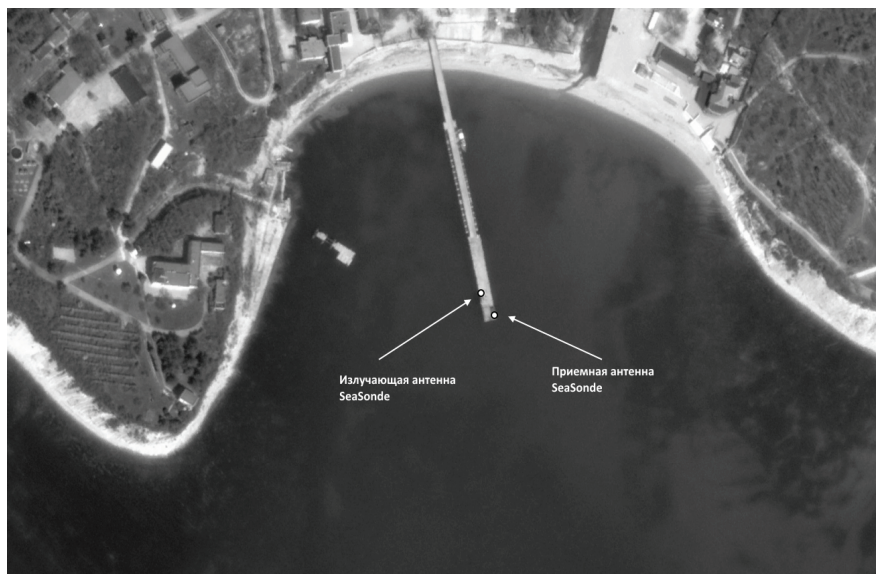
Рис. 1. Установка радиолокатора Sea Sonde, его передающей и приемной антенн на конце пирса ЮО ИО РАН в Голубой бухте в 2016 г.
